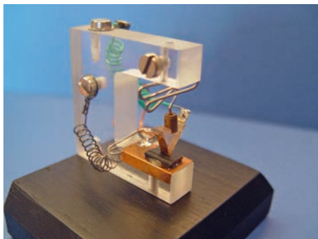
Versuchsanordnung von Bardeen und Brattain, Nachbau des Thüringer Museums für Elektrotechnik (Foto: Thüringer Museums für Elektrotechnik)
