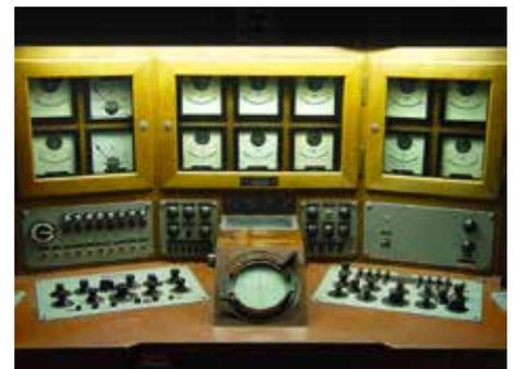
Messtisch für Polarkoordinaten- und Oszillographenröhren, Unikat, 1965
