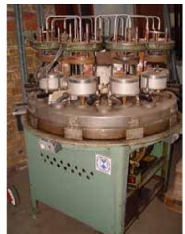
Einschmelzmaschine für Oszillographenröhren, Unikat, 1960
