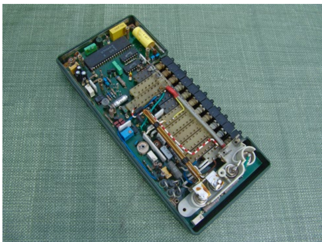
Multimeter G-1004.500, Innenansicht
