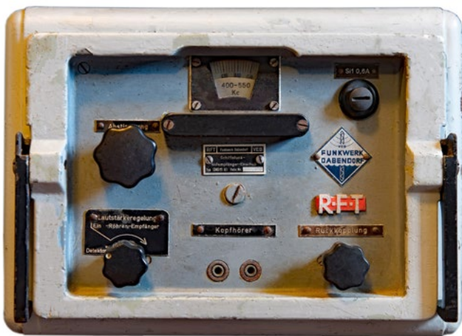
Batteriebetriebener Schiffsfunk-Notempfänger der 1950er Jahre, bestückt mit Batterieröhren des VEB Röhrenwerk Neuhaus am Rennweg
