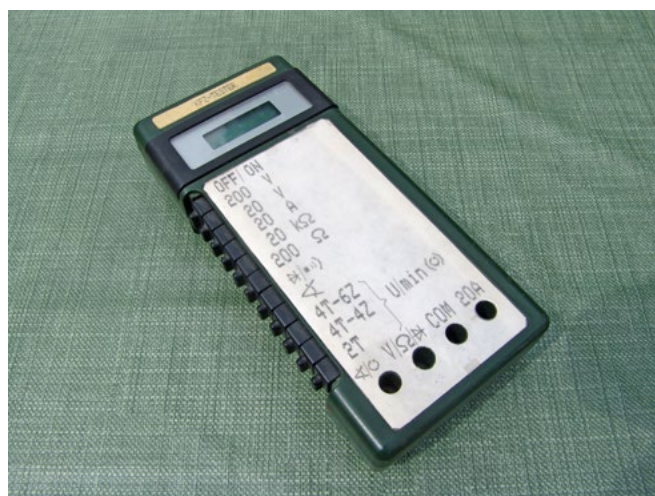
Labormuster des Kfz-Testers
