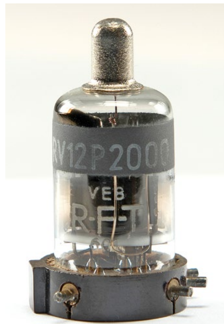
Die Universalpentode RV 12P 2000 wurde bis Mitte der 1960er Jahre im VEB Röhrenwerk Neuhaus (Neuhaus a. Rwg.) hergestellt.
