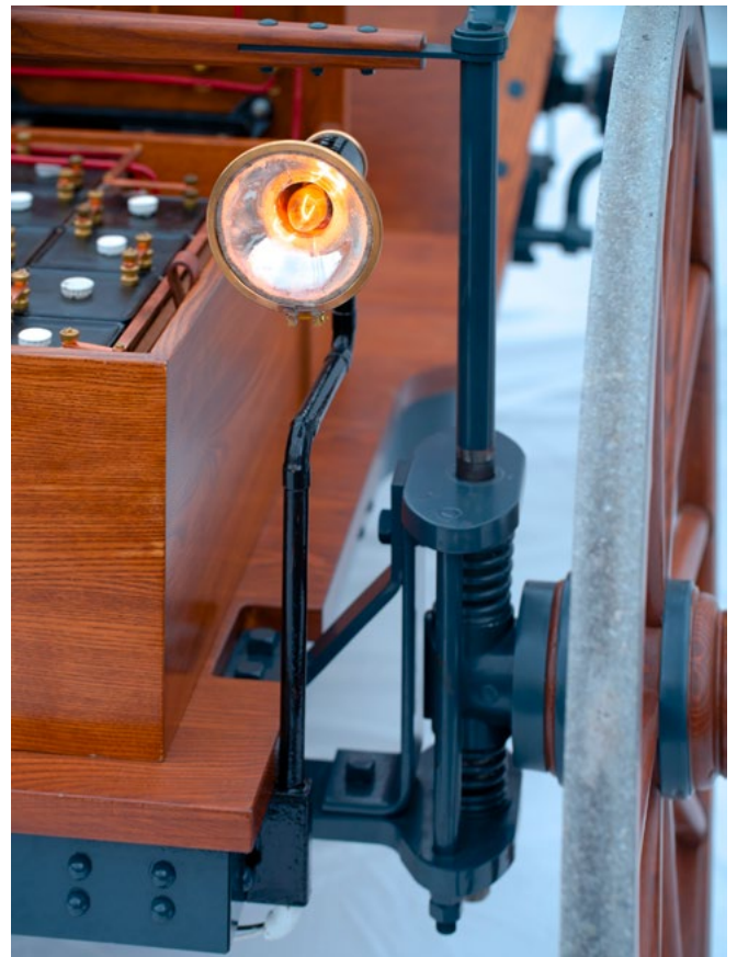
Detailansicht der gefederten Achsschenkellenkung, mit Scheinwerfer und Batteriekasten (Foto: Gerhard Kampe)
