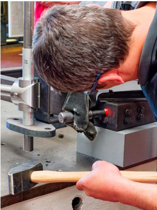
Nieten einer Metallverbindung am Grundrahmen (Foto: Gerhard Kampe)
