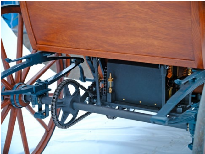
Antrieb, Hinterradfederung (Foto: Gerhard Kampe)
