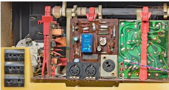
*Teil der Innenansicht des „Progress RR1201“: Links hinter den Antennenbuchsen der Drehkondensator und die UKW-Baugruppe, rechts daneben in Seitenansicht die FM-ZF-Platine, in der Mitte die Bestückungsseite des AM-Empfangsteils, rechts die Leiterseite des NF-Verstärkers.*
