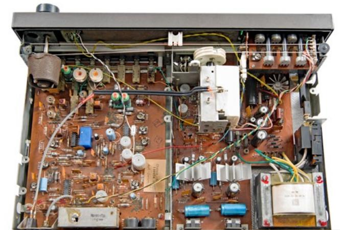
Bild: Chassis des Stereoempfängers „SR 2410“; die mit Kapazitätsdioden abstimmbare UKW-Baugruppe befindet sich unten links; auf der Achse des Drehkondensators für AM ist ein Potenziometer für die Abstimmspannung der Kapazitätsdioden montiert, so dass nur ein Skalenrad erforderlich ist.
