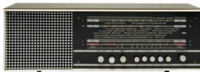
Heimempfänger „Elegant 6360“; ab 1971; Empfang von UKW, Lang-, Mittel- und Kurzwelle
