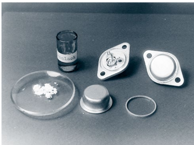
Einzelteile eines OC 846 A, 1962 (FWE-Bildarchiv im Thüringer Industriearchiv)
