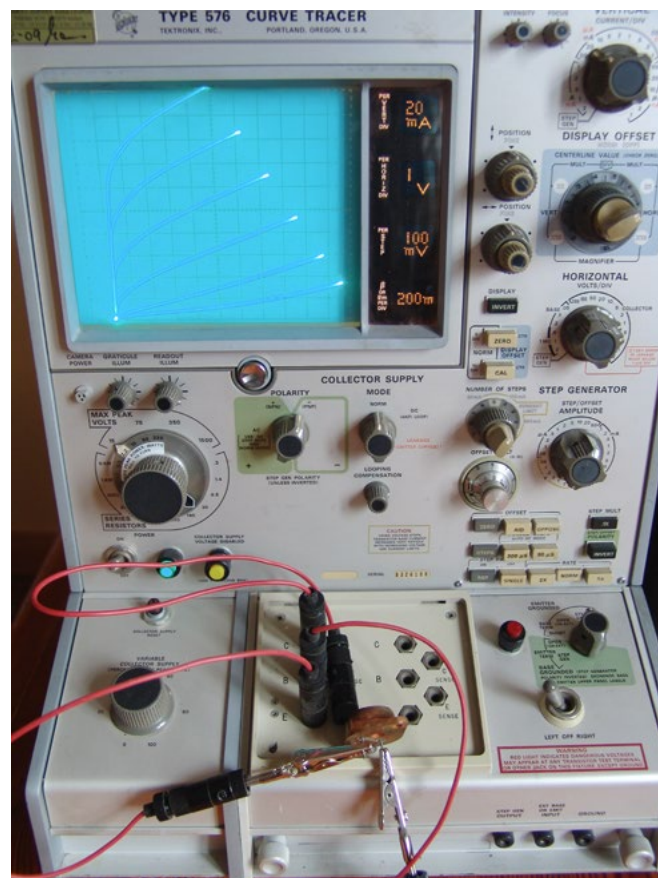
Kennlinie des OC 846 A auf dem Curve Tracer Typ 576, Tektronix
