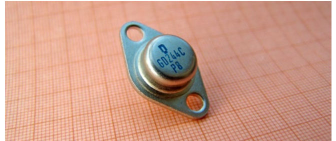
Germanium-Leistungstransistor GD 244, Sammlung Halbleitertechnik
