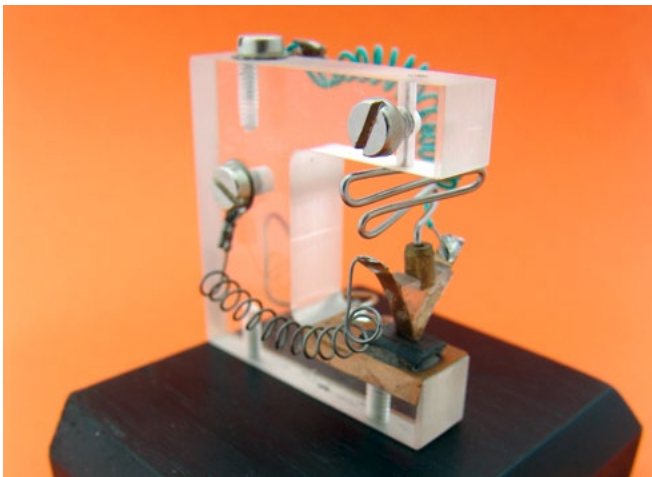
Maßstäblicher Nachbau des ersten (amerikanischen) Transistors, Peter Wächtler, 2010, Sammlung Halbleitertechnik
