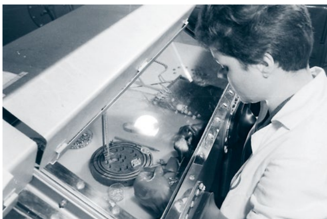
Montage der Transistorrohlinge, 1961 (FWE-Bildarchiv im Thüringer Industriearchiv)
