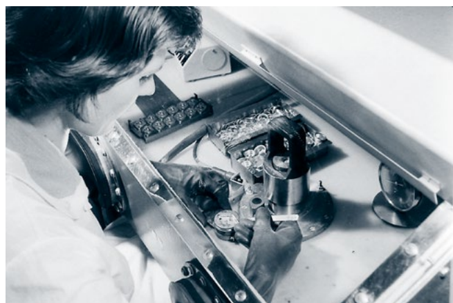
Verkappung der Transistoren, 1961 (FWE-Bildarchiv im Thüringer Industriearchiv)
