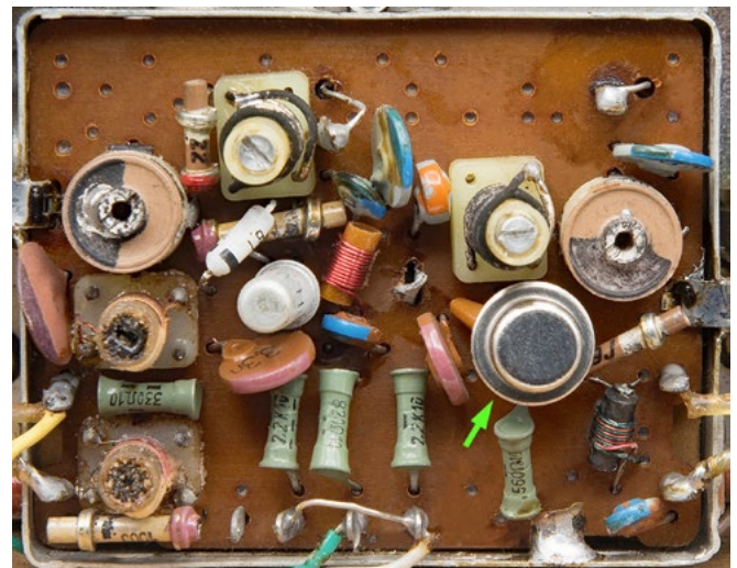
Die UKW-Baugruppe hat eine Grundfläche von 6 cm x 5 cm; als Vorstufen-Transistor wird bei diesem Gerät der sowjetische Typ GT 322 verwendet (Pfeil)
