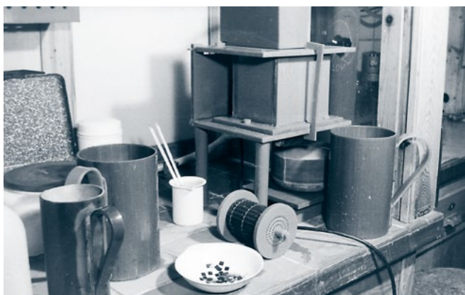
Chemische Oberflächenbearbeitung der Germaniumplättchen, 1961 (FWE-Bildarchiv im Thüringer Industriearchiv)
