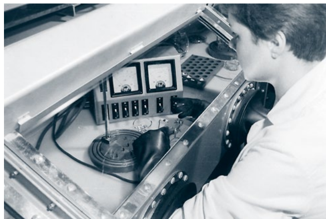
Kurzschlussmessung der Transistorrohlinge, 1961 (Foto: Josef Lorenz, FWE-Bildarchiv im Thüringer Industriearchiv)
